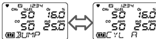
バンプテスト失敗後にガス校正を行う設定の場合、バンプテストに失敗したら自動でガス校正を実施します。
