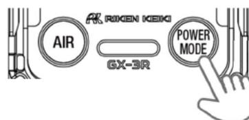
ブザーが“ピッピッピッ”と3回鳴り、表示部に「TURN OFF」と表示され、電源が切れます。
