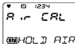
エア校正の結果、成功すると「**PASS**」が表示されます。
