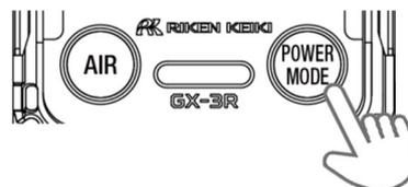
LCD 表示部が全点灯します。
