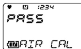
エア校正後の現在の濃度が表示され、ガス校正のメニュー画面に戻ります。
